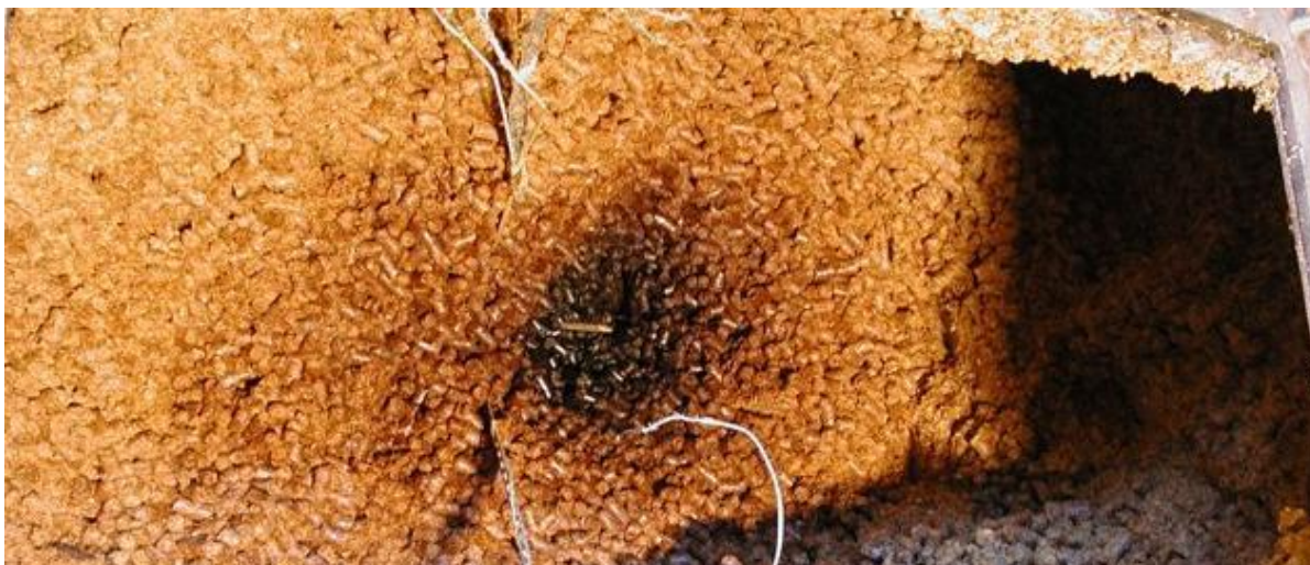
Önmelegedés és pirolízis nyomai biomassza mintában
