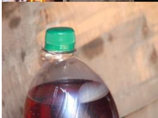
Tűzkísérlet szénsavas itallal teli, lezárt műanyag palackkal
