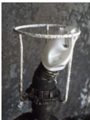
Tűz keletkezési helye felé hajló izzó, és üveg palack
