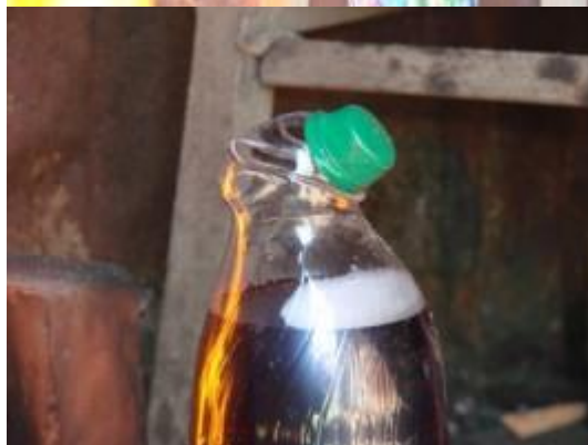
Tűzkísérlet szénsavas itallal teli, lezárt műanyag palackkal
